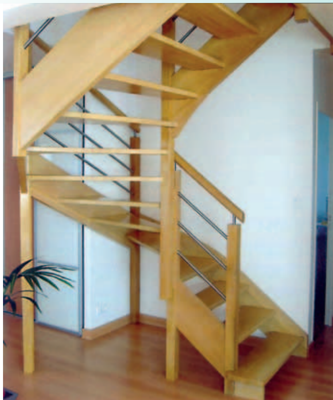
➤ Ri-4 Escalier 2/4 tournant sur limon, en bois exotique jaune, tête de poteau T6 sur poteau carré, sans contremarches, remplissage des rampes par lisses inox.
