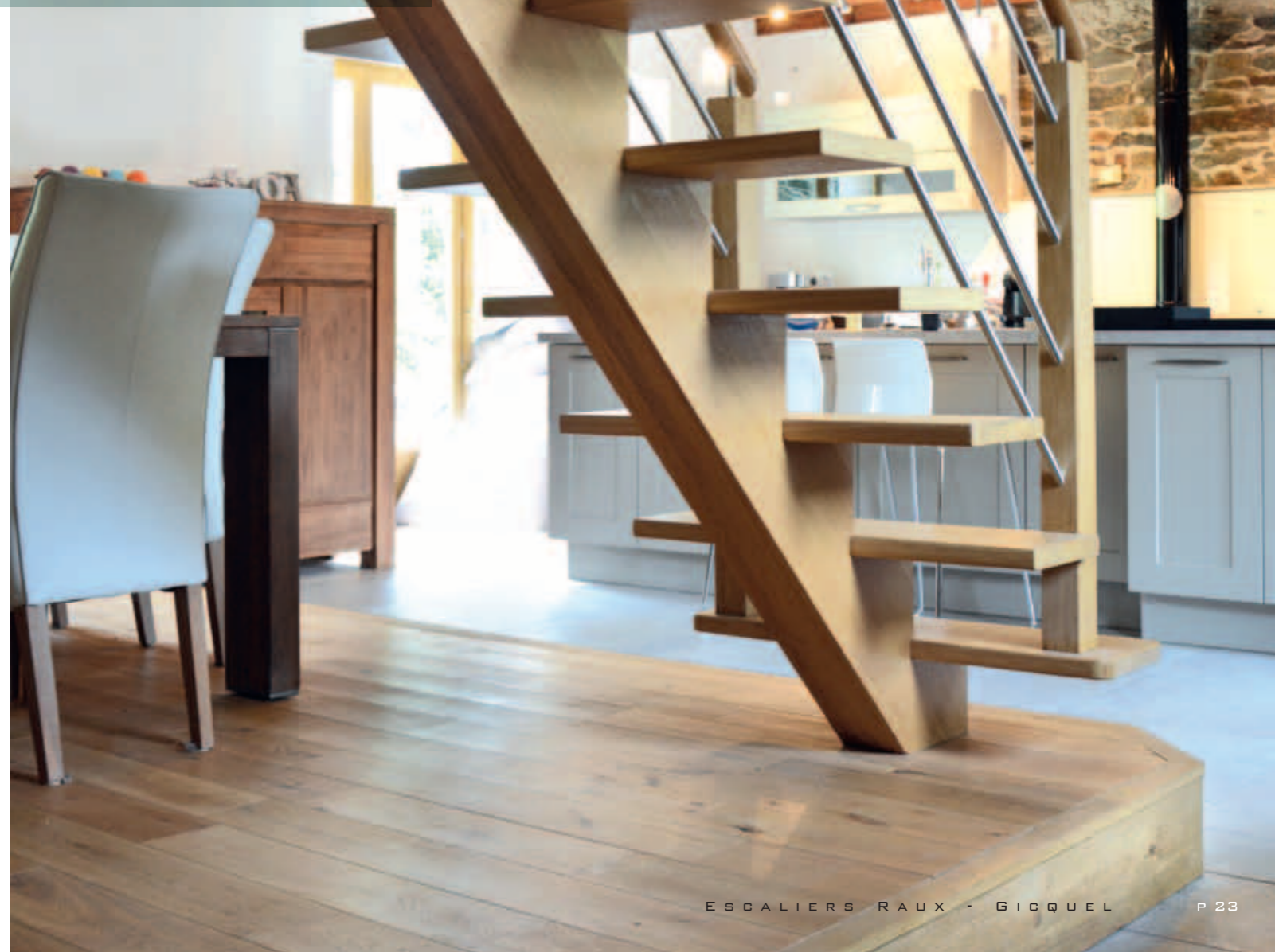
At-5 → Escalier droit en chêne sur limon central, marche de départ S2, remplissage des rampes par lisses inox. Possibilité de laquage de la structure et option de fixation des marches apparentes ou invisibles.
