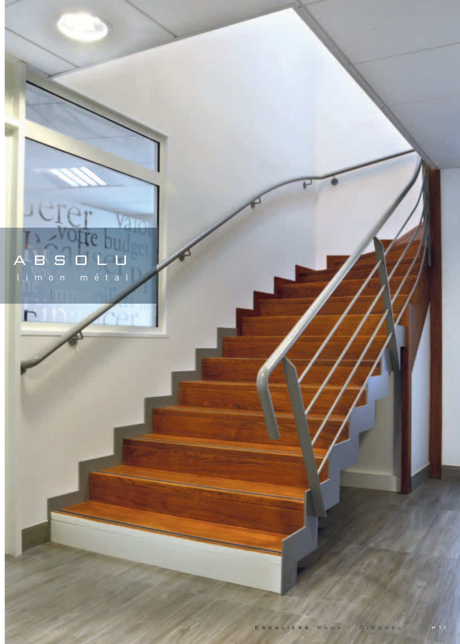
↔ Ma-5 → Escalier ERP métallique avec limon design découpe dessus dessous, rampe et main courante murale avec débord, bande antidérapante, nez de marche sans débord.
