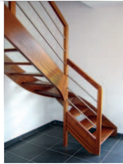
← Ho-2 : Escalier 1/4 tournant milieu sans marche de départ, poteau T3, sans contremarches, en bois exotique rouge.
