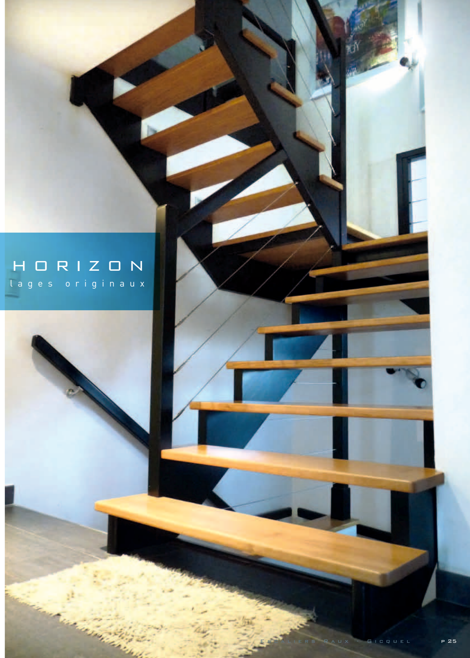
Ho-4 → Escalier 2/4 tournant structure laquée noire marches en frêne, marche de départ S2, poteau de départ T1, sans contremarches, remplissage des rampes par câbles inox.
