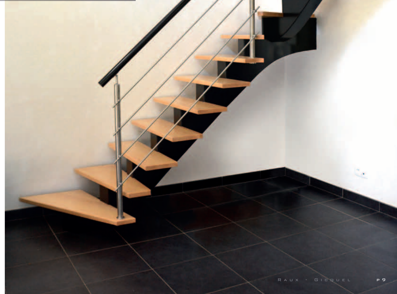
Mf-4 → Escalier 1/4 tournant milieu sur structure à limon central laqué noir, marches en frêne rampe à poteaux ronds inox (possibilité pour main courante en bois naturel, bois laqué, ou inox. Remplissage des rampes en rond inox ou câbles inox).
