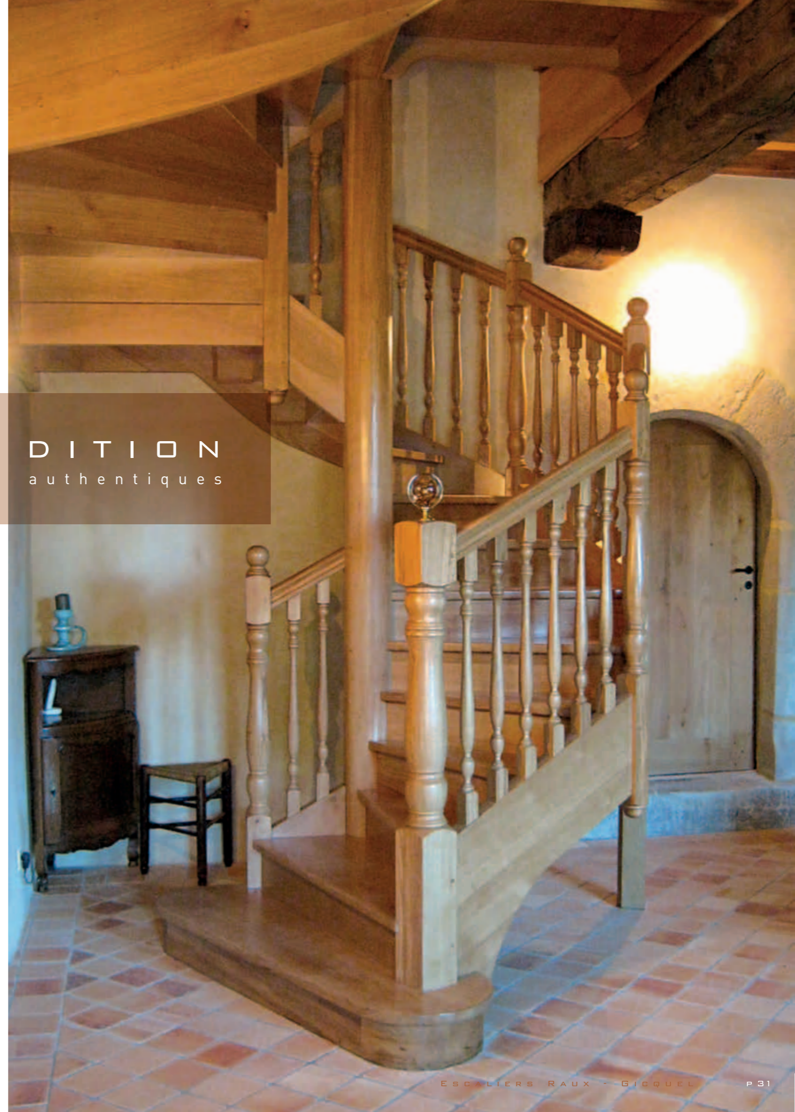
Tr-5 → Escalier 4/4 tournant en chêne évoluant autour d'un poteau tourné rond (diamètre 200 mm). Rampe extérieure octogonale constituée de poteaux d'angle tournés surmontés de boules. Poteau de départ principal surmonté d'une boule en verre. Marche de départ S4.
