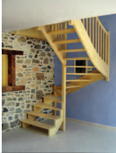
➤ Ep-1 : Escalier 2/4 tournant en bois exotique jaune, départ sur crémaillère à l'anglaise avec ajustage des marches sur mur en pierre, marche de départ S1, poteau de départ T1, sans contremarches, remplissage des rampes par balustres bois.
