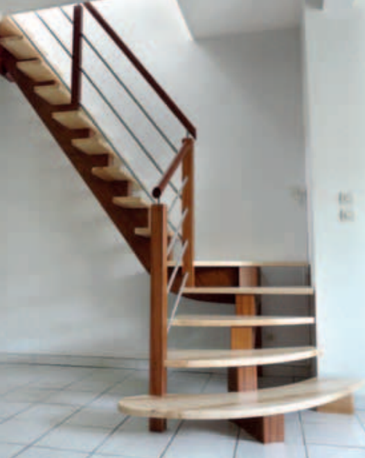
← At-1 Escalier ¼ tournant milieu structure en bois exotique rouge, marches en frêne gris, marche de départ galbée S7, poteaux T6, remplissage des rampes par lisses inox.
