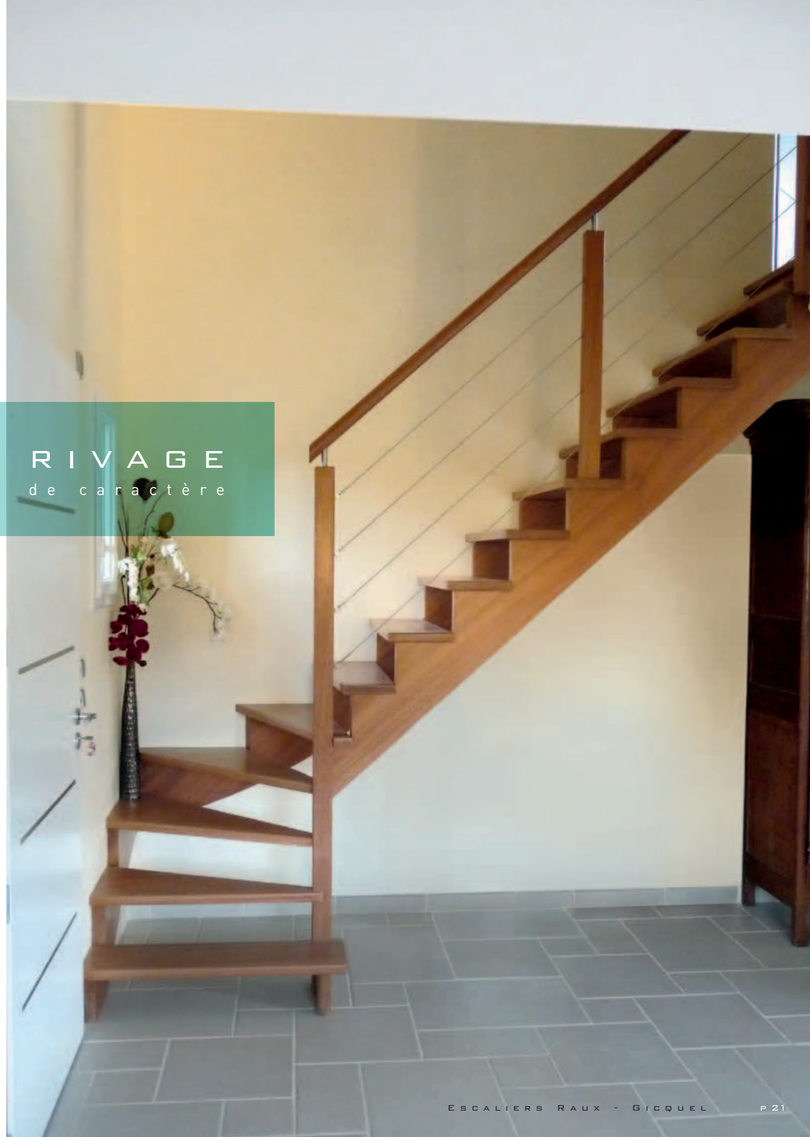
Ri-5 ➔ Escalier 1/4 tournant sur crémaillère à "l'anglaise" en bois exotique rouge, tête de poteau T6 sur poteau carré, sans contremarches, remplissage des rampes en câbles, marche de départ S1.
